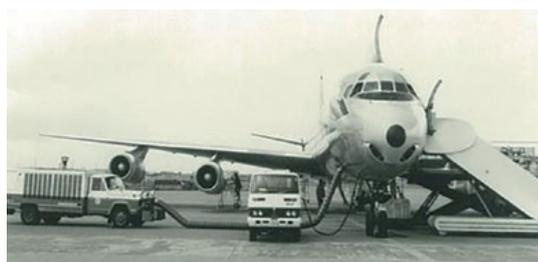
固定式埋設型GPUによる供給作業の様子
