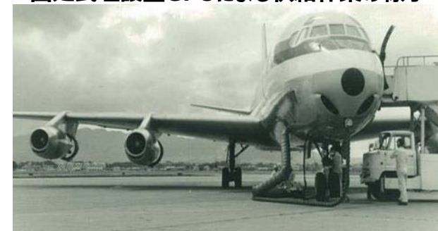
固定式埋設型GPUによる供給作業の様子
