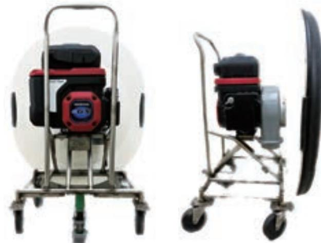
※ ブレーキクーリングカートは、航空機の着陸時にブレーキから発生する熱が、一定温度以上の高温となった場合、航空機の運航に支障がでる可能性があるため、高温になったブレーキを冷却する機材で、370℃から150℃まで約25分で冷却することが可能。
