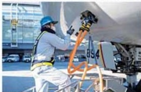
機体のターボファンエンジンに電力供給する「固定式GPU」の運用の様子。機体側には「固定式GPU」のケーブルが接続されている。機体側には「固定式GPU」のケーブルが接続されている。機体側には「固定式GPU」のケーブルが接続されている。
