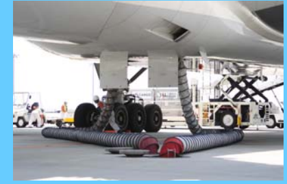
ACU(エアコン供給)
