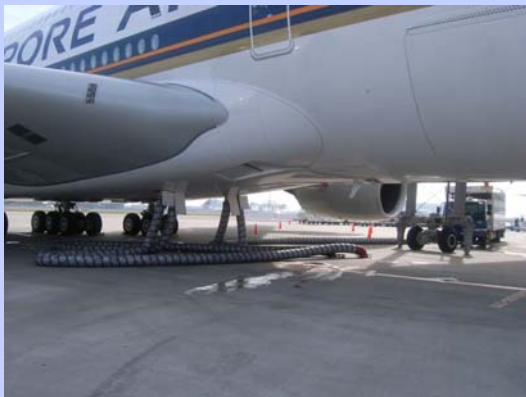
ACU(エアコン供給)
