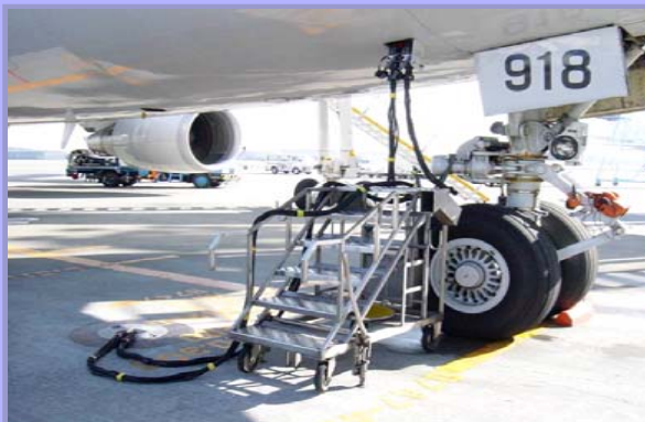
GPU (電力供給)
