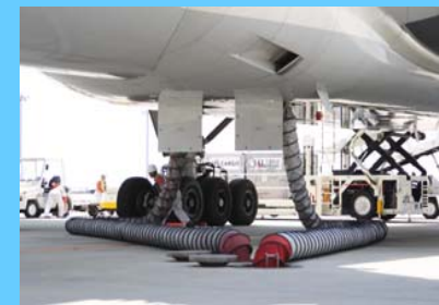
ACU(エアコン供給)
