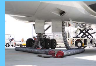
ACU(エアコン供給)
