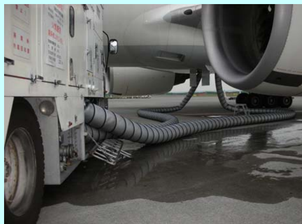
冷暖房気供給作業
