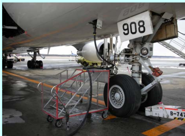
電力供給作業
